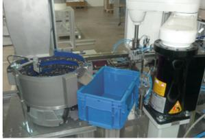
Durch die Kombination von flexiblen Zuführsystemen mit den Wendelförderer- sowie Palettiersystemen von MAFU Automation können zusätzliche Montageaufgaben realisiert und im Anschluss die fertigen Produkte in Trays/Paletten gesetzt sowie die voll bestückten Trays/Paletten gestapelt werden.
