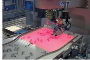
Durch die Kombination von flexiblen Zuführsystemen mit Entwirntechnologie von MAFU Automation können unterschiedlichste Feder-Geometrien wie z.B. Kegelfedern, Tonnenfedern, Kelchfedern etc. gehandhabt werden.
