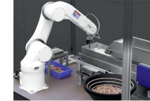
Durch die Kombination von flexiblen Zuführsystemen mit den Wendelförderern von MAFU Automation können zusätzliche Montageaufgaben realisiert werden.
