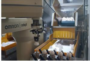
Durch die Kombination von flexiblen Zuführsystemen mit 2-fach Bereitstellung von MAFU Automation können unterschiedlichste Werkstück-Geometrien zu selben Zeit dem Roboter bereitgestellt werden und erhöhen somit die Verfügbarkeit der Anlage.
