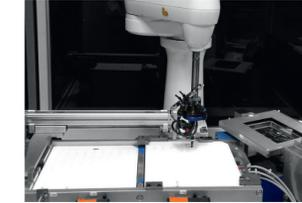
Durch die Kombination von flexiblen Zuführsystemen mit den Palettiersystemen von MAFU Automation können unterschiedlichste Werkstücke in Trays/Paletten gesetzt sowie die bestückten Trays/Paletten gestapelt werden.
